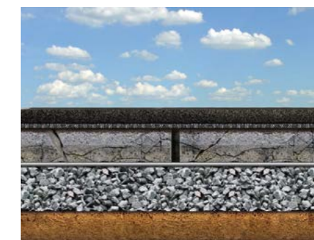
Sanierung von Betonflächen mit Asphalt
