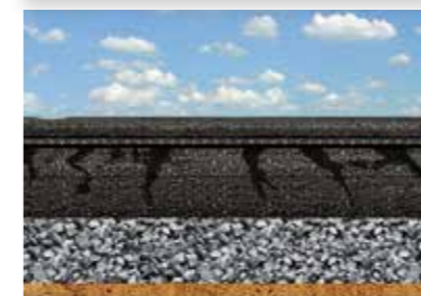
Renovatie van asfaltverhardingen
