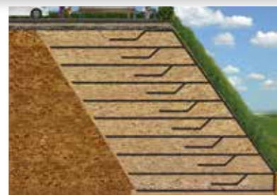
Steile taluds, gewapende constructies
