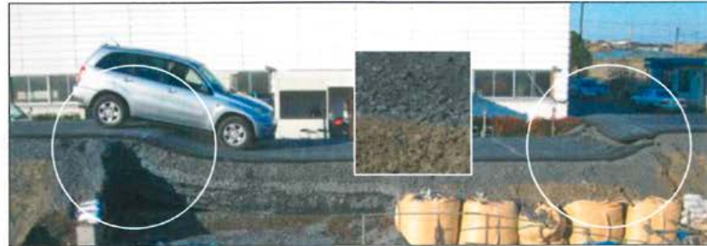
7 Verformter geogitterbewehrter (li.) und unbewehrter (re.) Straßenoberbau über einem Versprung (persönliche Korrespondenz) Quelle: HUESKER
