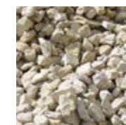
Drainage laag van gebroken steen
