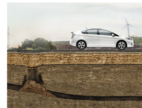
Overbrugging van zettingen
