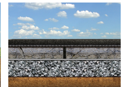
Renovaties van betonverhardingen met asfalt
