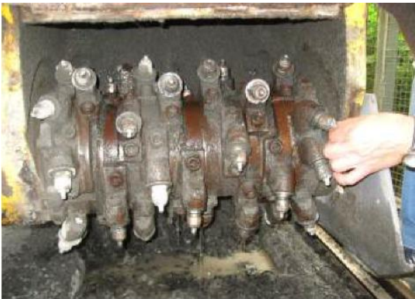
Figure 12 : Fraisage aisé d'un enrobé renforcé par la grille polyester
