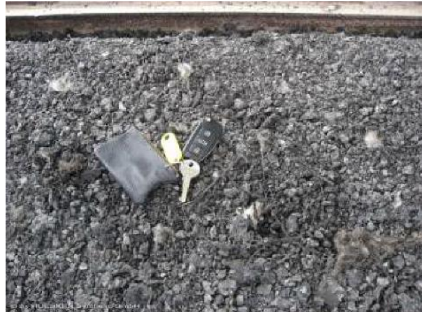
Figure 12 : Fraisage aisé d'un enrobé renforcé par la grille polyester
