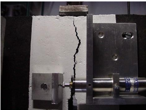
Figure 6 : Echantillon non renforcé soumis au moment fléchissant après 80 000 cycles (à gauche) Echantillon renforcé soumis au moment fléchissant après 490 000 cycles (à droite)
