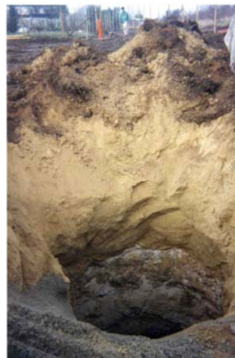
Figure 3. Ouverture d'un fontis en surface
